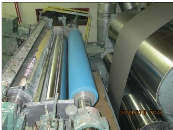
เครื่องเคลือบสีด้วยลูกกลิ้ง (เคลือบด้านหน้า)
