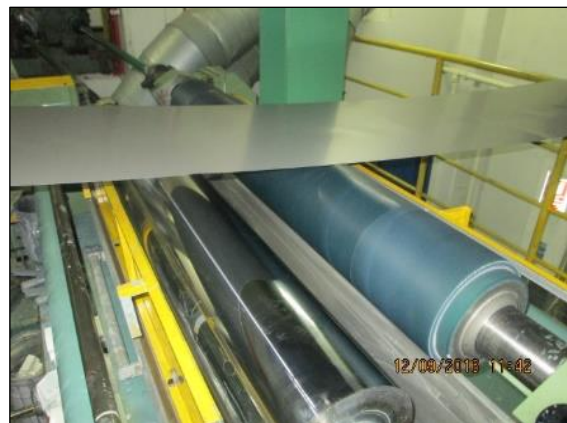
เครื่องเคลือบสีด้วยลูกกลิ้ง (เคลือบด้านหลัง)
